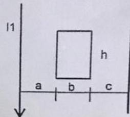
b) Si la espira fuese conductora con resistencia óhmica  $R$  y autoinductancia  $L$  y la corriente  $I_1$  variara en el tiempo:  $I_1(t) = I_m \cos(\omega t)$ , calcular el valor eficaz de la corriente inducida en la espira, suponiendo que la corriente en el segundo conductor es la corriente constante  $I_2$  que se calculó en el punto anterior.
